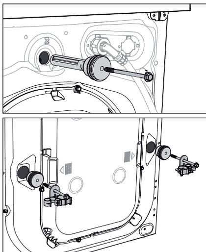
⚠ 在使用洗衣機前，必須拆除所有搬運部分 (3 個組成部分)。
