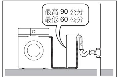
排水軟管出水端必須保持暢通，即排水管道的內徑必須大於排水軟管的外徑。
