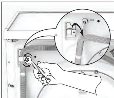
4. 將排水軟管和進水軟管的末端放在一個容器內。讓軟管內的水流出。
