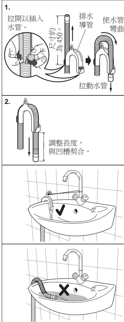
採用這種方式時，請確保出水端不會在洗衣機排水過程中脫落。要做到這一點，可將排水軟管繫在水龍頭上或固定在牆上。
