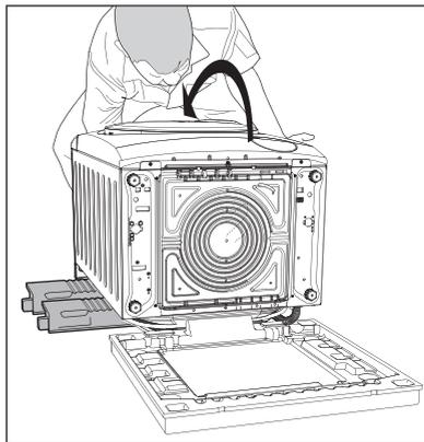
5. 拆下聚苯乙烯泡沫底座。
