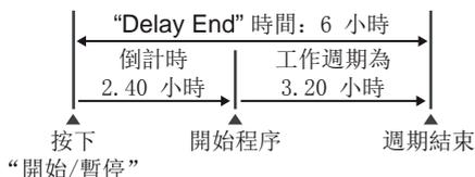
選擇“延遲結束”時間後，按下“開始/暫停”觸摸板，開始該程序。然後洗衣機將進入倒計時並在顯示器上每隔數小時就更新時間一次，直到它到達洗滌週期的起點。如果開始該程序之後您想修改或取消“延遲結束”選項，請執行以下步驟：
