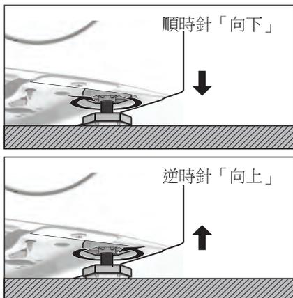
調整好洗衣機並達水平之後，嘗試從各個邊角搖動它。如果洗衣機發生晃動，請再次調整機腳，直到洗衣機保持水平並且不再搖晃為止。
