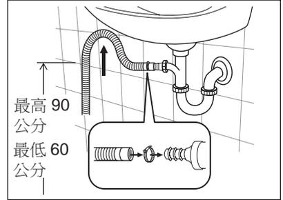
將排水管推到水龍頭，並用夾子固定，確保在排水管中形成一個迴路，防止水槽中的廢棄物進入裝置。
