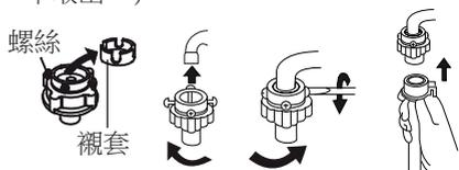
4. 按住供水軟管連接頭上的滑動器往下壓，將其固定在連接頭的另一側，並放開滑動器。
