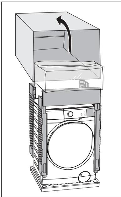
3. 打開機門。取出門封處的聚苯乙烯泡沫塊，以及洗衣滾筒內所有物品。
