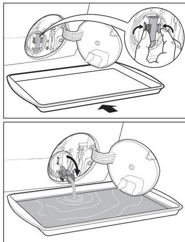
3. 容器水滿後，將疏水管放回原位，然後倒掉容器中的水。重複第 2、3 步，直到排水泵不再流水為止。
