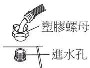
6. 旋入擰緊塑膠螺母讓供水軟管與進水孔連接牢固。
